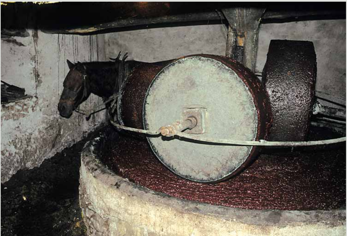
Ιπποκίνητο ελαιοτριβείο στο Σαρπιντζίκι (φωτ. Αϊντίν Τσετίνμποστάνογλου, 1996).
